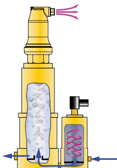
Prinzip der Druckstufenentgasung
